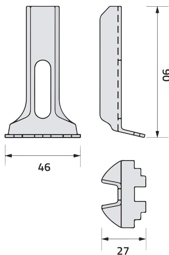
Gracias a su diseño versátil, el clip L para rejillas de piso es ideal para aplicaciones en pisos industriales, pasarelas, plataformas y zonas de circulación técnica. Esta solución ofrecida por Proindar garantiza una instalación segura, rápida y eficiente, alineada con las exigencias de la industria y las buenas prácticas de montaje de grating.
